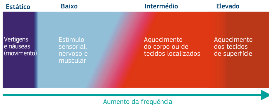
Figura 2.1 — Os efeitos dos campos eletromagnéticos em diferentes gamas de frequências (as gamas de frequência não são apresentadas à escala)
