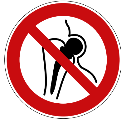
Acesso proibido a pessoas com implantes metálicos
