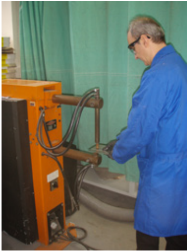
Figura 9.10 — Ilustrações de boas e más práticas quando se organiza o posto de trabalho para um soldador por pontos e se tem em conta o posicionamento do operador
