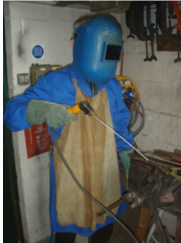
Figura 9.11 — Exemplos de boas e más práticas na passagem do cabo de soldadura por arco
