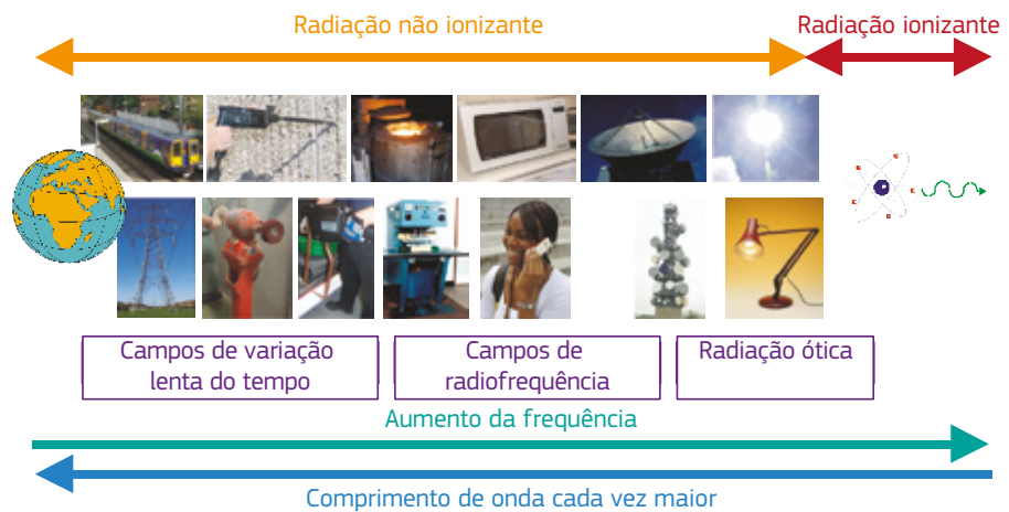
Figura 3.1 — Representação esquemática do espectro eletromagnético juntamente com algumas das fontes típicas
