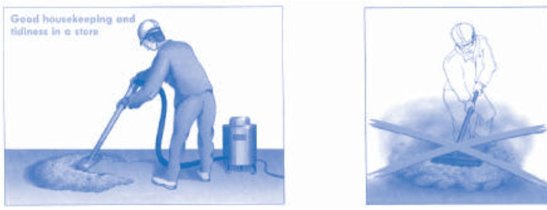
Figura 3.2: Eliminazione dei depositi di polveri. 9
