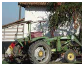
Trattore con barre antiribaltamento
