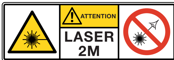
Fig. 10: étiquetage de la classe laser 2M. Il est également possible d'utiliser le même étiquetage qu'au chapitre 6.2.
