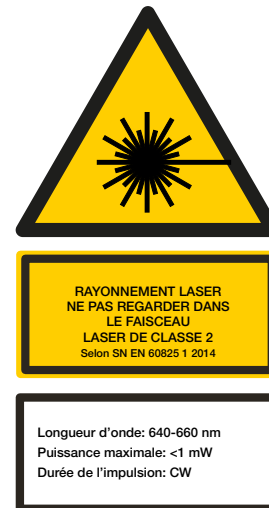
Fig. 17: exemple d'étiquetage pour un laser de classe 2
