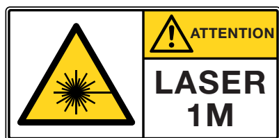
Fig. 6: étiquetage de la classe laser 1M. Il est également possible d'utiliser le même étiquetage qu'au chapitre 6.2.
