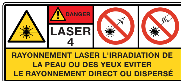
Fig. 13: étiquetage de la classe laser 4. Il est également possible d'utiliser le même étiquetage qu'au chapitre 6.2.
