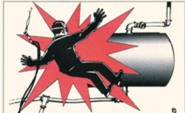
Figure 1 : explosion due à un dégazage incomplet
