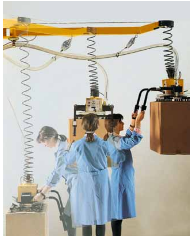
Fig. 22: l'équilibreur de charges permet de déplacer des charges avec un minimum d'efforts.
