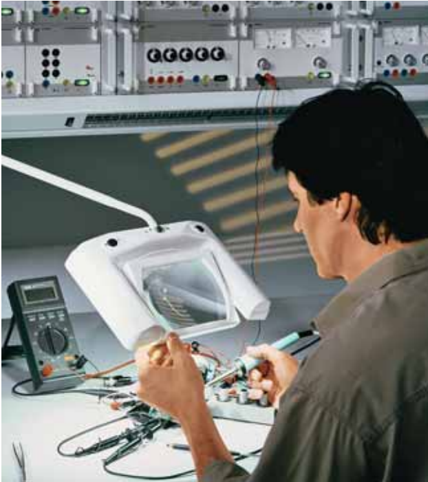
Fig. 31: un éclairage correct et le grossissement des objets sont indispensables à ce poste de travail.
