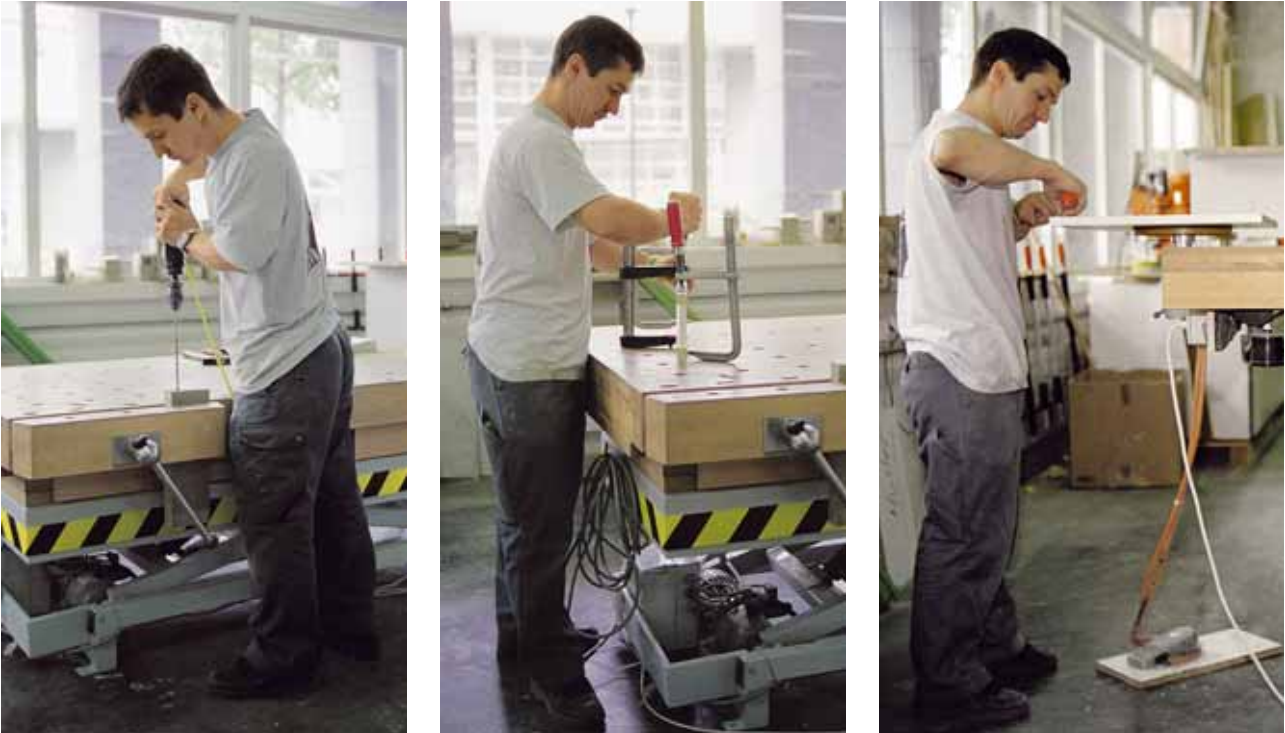
Fig. 14, 15 et 16: la hauteur de cet établi est modulable en fonction des tâches à effectuer.
