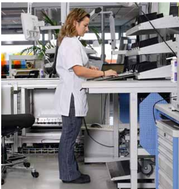
Fig. 10 et 11: les postes de travail doivent permettre d'alterner les positions assise et debout, comme ici pour le montage de précision.
