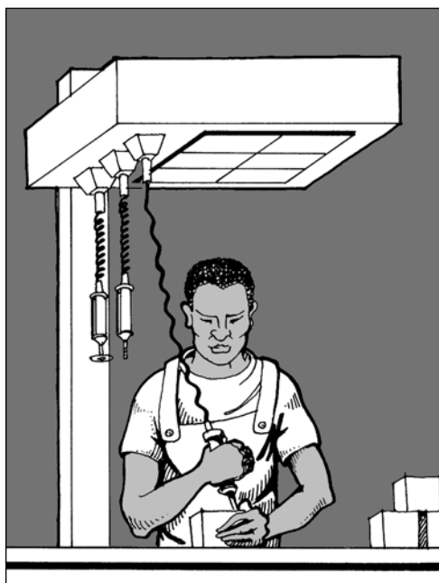
Figure 24c. Prévoir un support en hauteur spécifique pour suspendre les outils au moyen de dispositifs à ressort
