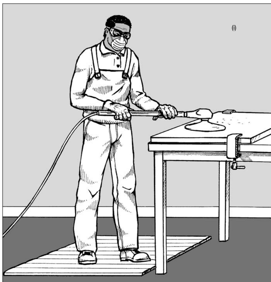
Figure 36. (i) et (ii) Une surface stable, avec un bon équilibre et une hauteur de service adaptée, environ à la hauteur du coude, est indispensable pour utiliser les outils à moteur de façon productive et sans danger
