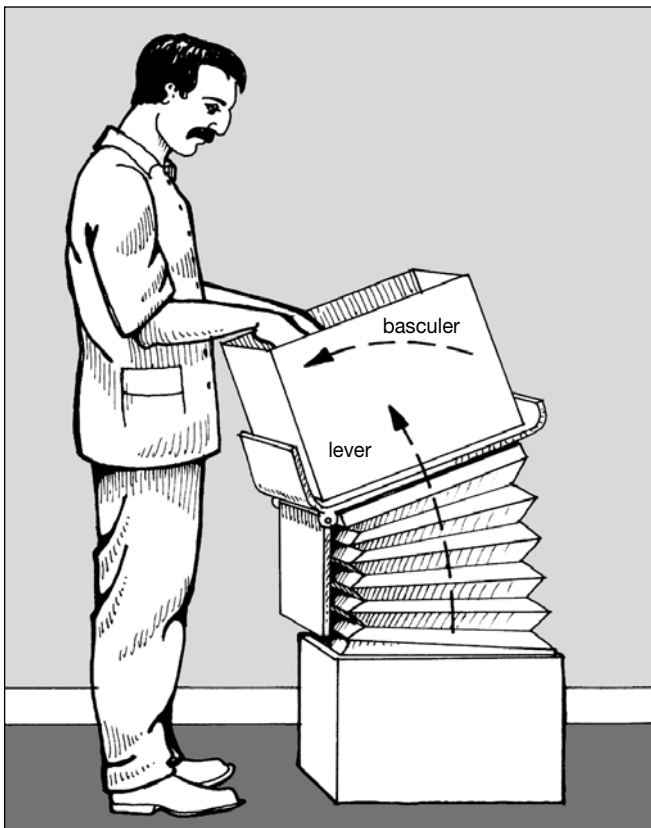
Figure 63a. Il est toujours préférable d'exécuter les tâches devant soi, à hauteur du coude ou légèrement en-dessous. Utiliser un système de levage ou de bascule, si nécessaire
