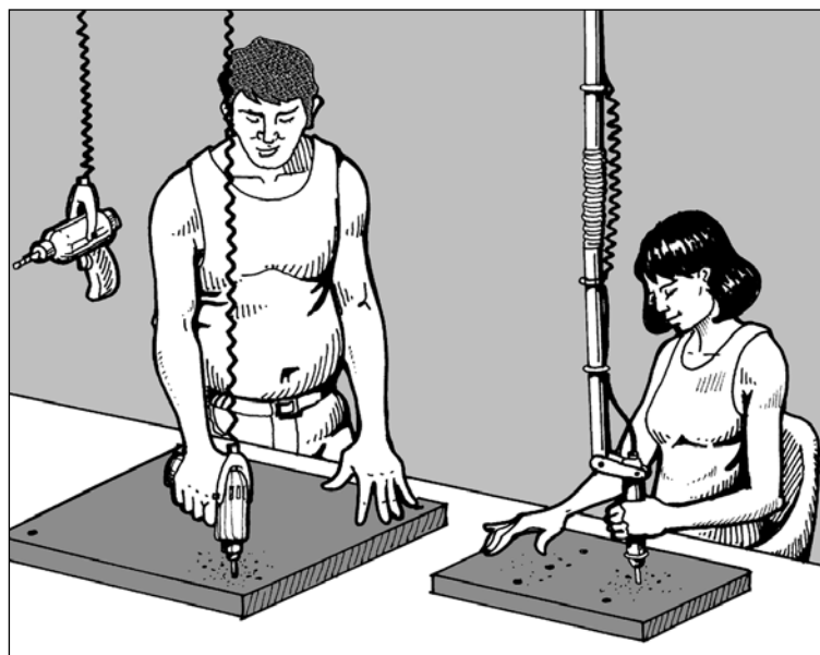
Figure 24b. Les outils suspendus à portée de main des opérateurs sont bien adaptés aux travaux répétitifs
