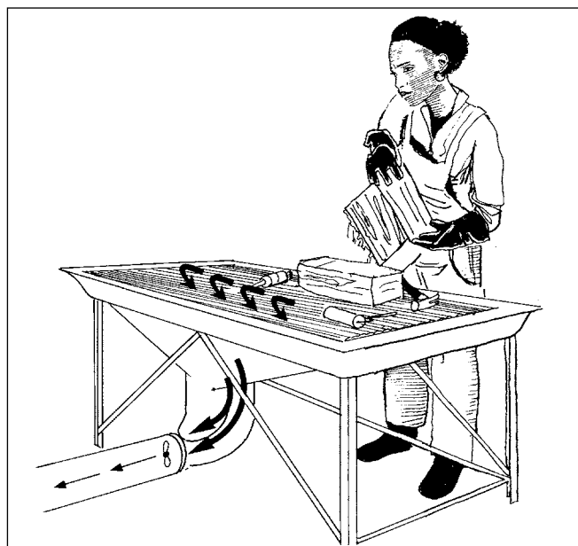
Figure 94b. Autre système de ventilation local : aspirer les polluants de la table de travail avant qu'ils n'atteignent la sphère de respiration de l'opérateur
