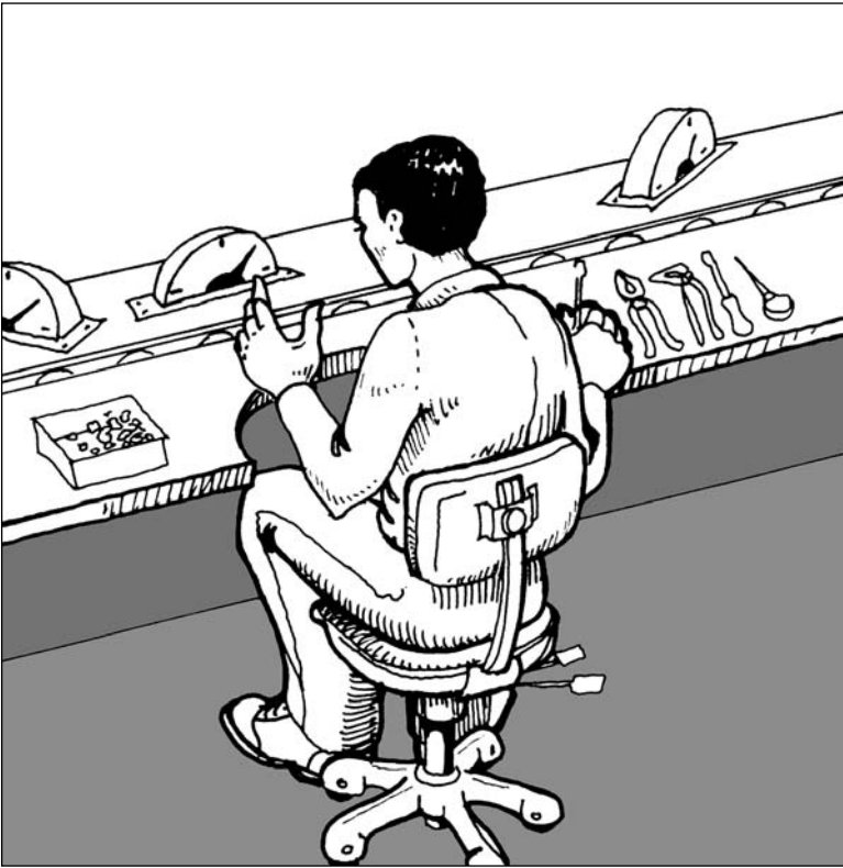
Figure 61. Prévoir une surface de travail polyvalente stable pour chaque poste de travail
