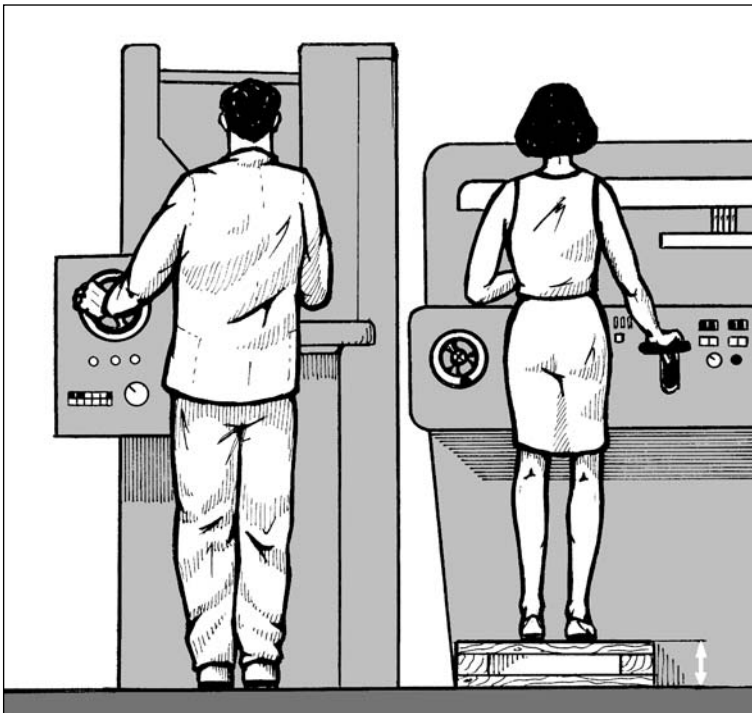
Figure 58a. Fournir aux personnes de petite taille travaillant en posture debout une plate-forme pour ajuster la hauteur de service à celle du coude
