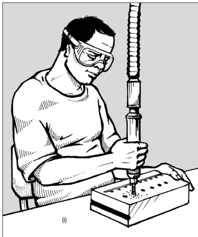
Figure 27a. (i) et (ii) Suspending l'outil au-dessus de son centre de gravité permet de l'utiliser plus facilement et plus efficacement
