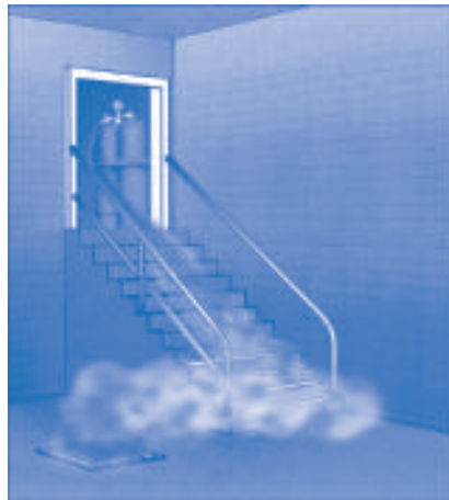
Fig. 2.3: Mode de propagation de gaz liquéfiés (exemple) 6 .
