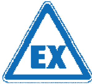
Fig. 4.3: Panneau d'avertissement signalant les emplacements dangereux.
