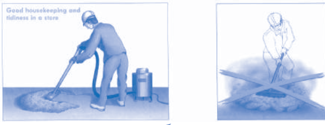
Fig. 3.2: Élimination de dépôts de poussières 9 .
