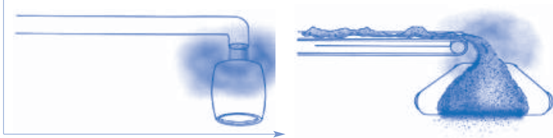
Fig. 2.2: Exemples de formation de mélanges poussières/air lors d'opérations de remplissage et de transport 5 .
