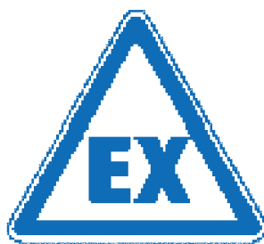
Figura 4.3: Señal de advertencia para identificar las áreas con riesgo de explosión.
