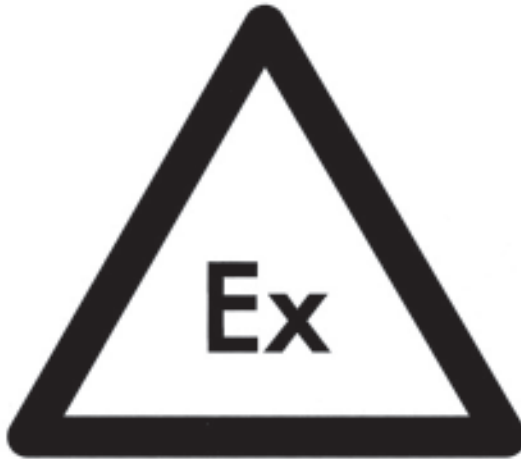
Zona con riesgo de atmósferas explosivas
