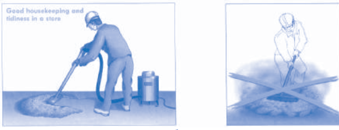
Figura 3.2: Eliminación de depósitos de polvo 9
