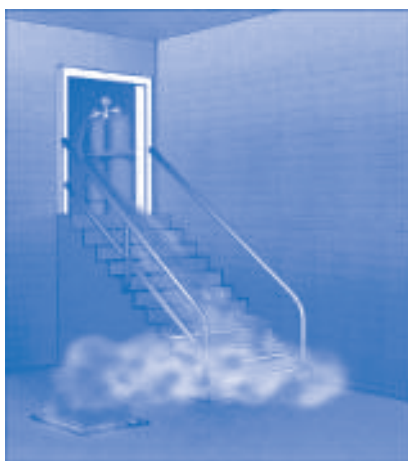
Figura 2.3: Modo de propagación de los gases licuados (ejemplo) 6 .
